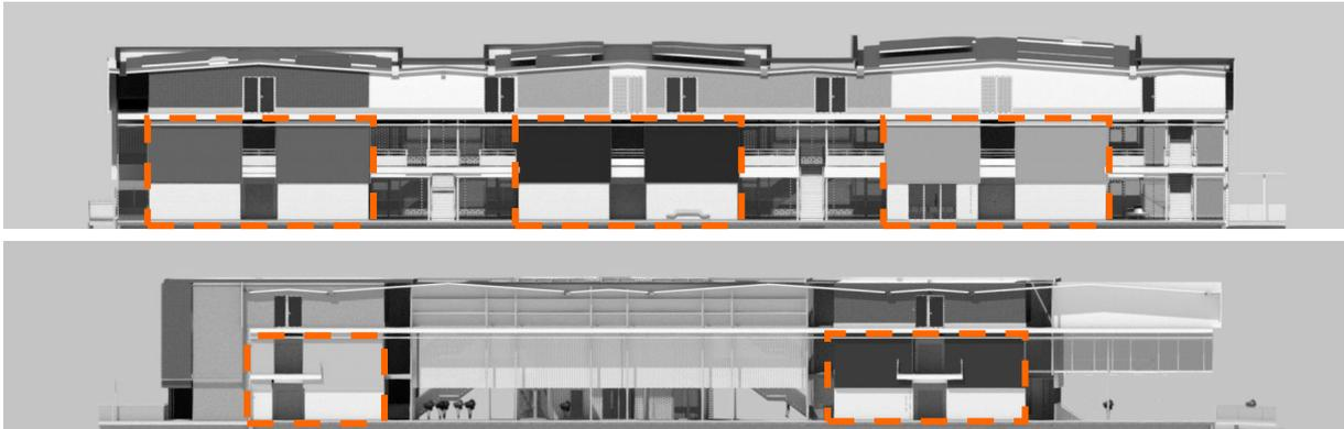
Illustrations : Elévations intérieures du bloc 0 – Mise en évidence des bardages sur structure légère
